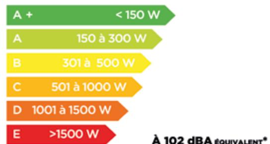
\*La valeur donnée représente la puissance électrique consommée par l'enceinte pour reproduire sur sa bande de fréquence un niveau sonore équivalent de 102 dBA avec un bruit rose. Pour le calcul l'enceinte est considérée comme faisant partie d'un système égalisé ayant une réponse en fréquence absolument plate de 20Hz à 20kHz.
