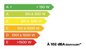
\*La valeur donnée représente la puissance électrique consommée par l'enceinte pour reproduire sur sa bande de fréquence un niveau sonore équivalent de 102 dBA avec un bruit rose. Pour le calcul l'enceinte est considérée comme faisant partie d'un système équalisé ayant une réponse en fréquence absolument plate de 20Hz à 20kHz.
